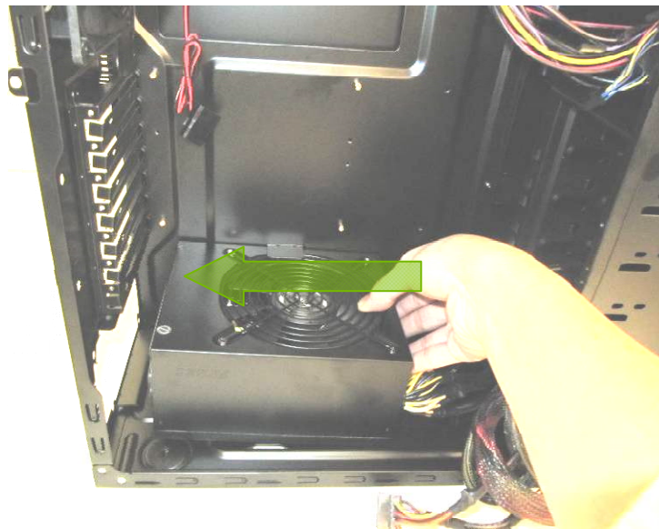
標準 ATX 電源を電源マウントに取り付けるイメージ
