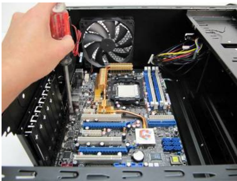
ステップ5: スペーサー取り付け後のマザーボードのネジ留め
