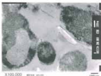
図 ブロックPP/G1657(SEBS)/タルク=67/12/21%wtのTEM写真
