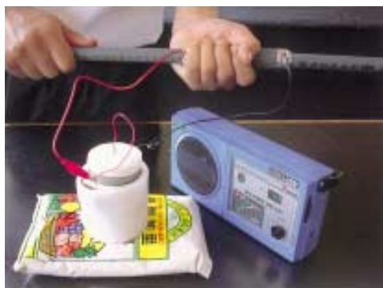
写真1 携帯型静電気計数管と棒起電器
