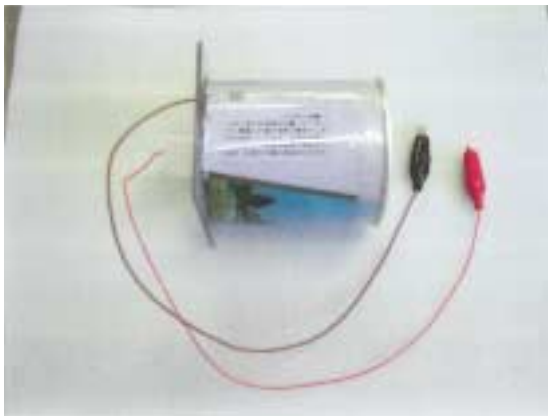
写真5 空き缶ガイガー計数管
