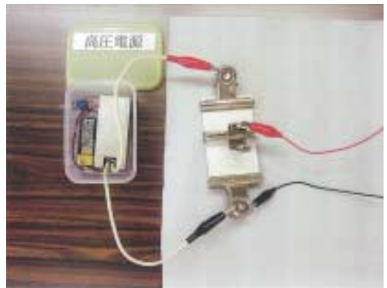
写真3 小型高圧電源と紙製の電圧調整器
