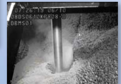
海底を掘削中のボーリングマシンの様子(中央の銀色の棒が、岩石を掘るロッド)
