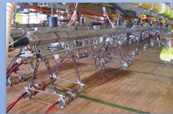
資源に搭載される地震探査用のエアージェン(震源装置)
