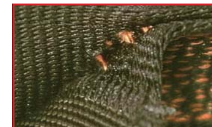
壁落による縫製糸の伸び (注意が必要)
