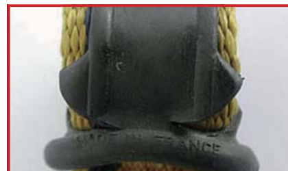
『ストリング』のひび割れ (要修理)
