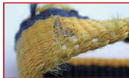
ウェビングの繊維のほつれ、切れ目 + ウェビングの磨耗 (廃棄)
