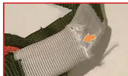
保護カバーの損傷、ウェビングの状態は良好 (要修理)
