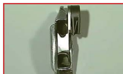
ハンドルの折損 (要修理)
