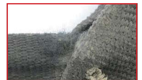
アタッチメントポイント付近のウェビングの縁のすり切れ (廃棄)
