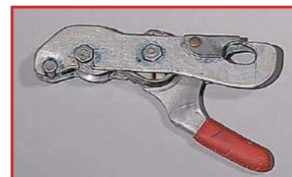
ローボビンのスプリングが効かなくなっている (要修理)
