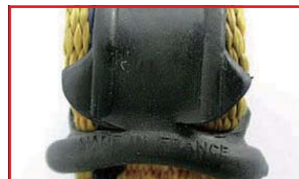
『ストリング』のひび割れ(要修理)
