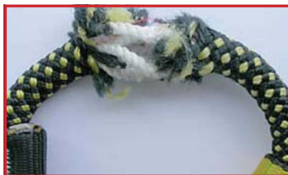
外皮の切断、芯の損傷 (廃棄)
