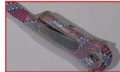
切れ目が入った保護カバー (注意が必要) カバーをずらし、縫製箇所を点検してください。 縫製箇所に異常がない限りは使用できます
