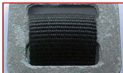
腐食したバックル (廃棄)
