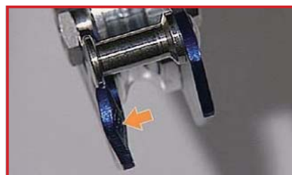
サイドプレートの変形 (廃棄)
