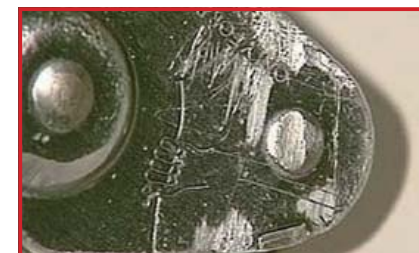
リベットが大きく損傷している (廃棄)
