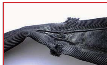
レッグループのバイアステープの損傷 (廃棄)
