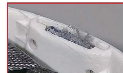
ウェビングハンモックの損傷 (廃棄)
