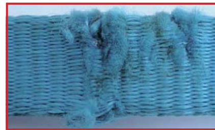
スリングが裂け始めている (廃棄)
