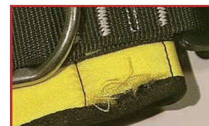
背部サポート部分の損傷 (要修理)
