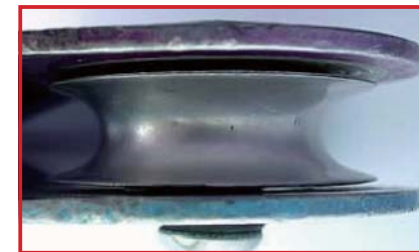
過度の磨耗により、滑車の溝が深くなり、縁が鋭くなっている (廃棄)
