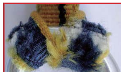
ひばり結びの激しい磨耗 (廃棄)
