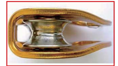
細すぎるケーブルを使用したことによる滑車の磨耗 (廃棄)
