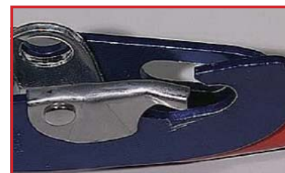
クリップの変形 (要修理)
