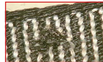
熱による縫製系の切断 (廃棄)
