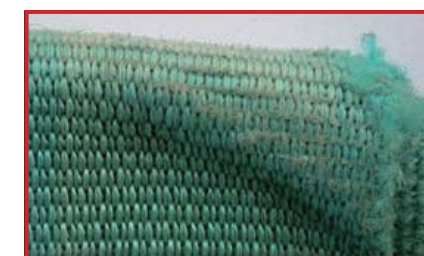
レッグループがハーネスに接続する部分のウェビング損傷の初期症状 (注意が必要)
