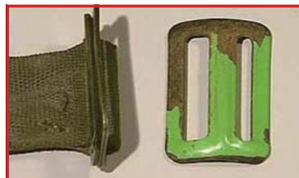
調節バックルの変形と腐食 (廃棄)
