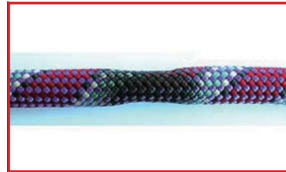
化学薬品との接触によるロープの収縮 (廃棄)
