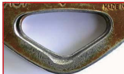
アタッチメントポイントが、コネクターと接触する部分にかかる荷重で変形 (注意が必要) 他の症状が出たら廃棄してください
