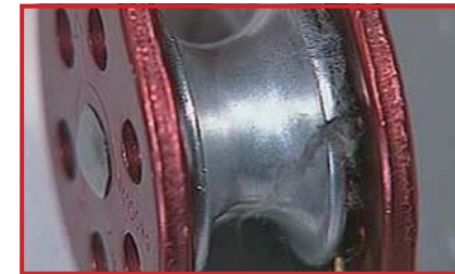
滑車まわりの汚れ (要修理)
