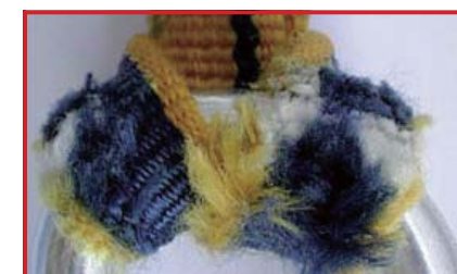
ひばり結びの激しい磨耗(廃棄)
