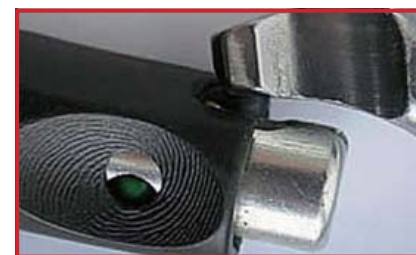
「ボールロック」システムの故障 (廃棄)
