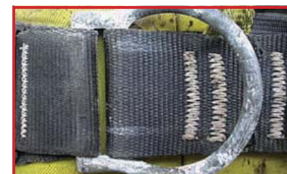
側部アタッチメントリングの腐食 (注意が必要)
