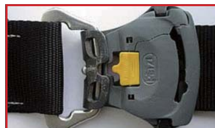
「FAST」バックルのプラスチック部分の破損 (廃棄)
