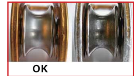
細すぎるケーブルを使用したことによる滑車の磨耗 (廃棄)
