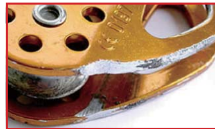
衝突の繰り返しによるプレートの傷 (注意が必要) 傷はアタッチメントポイントから離れた位置にあり、深さは1mm以内
