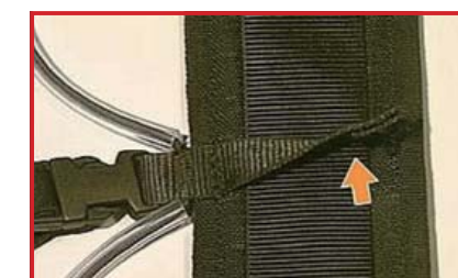
ストラップリテーナーの損傷 (要修理)
