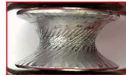
ケーブルの使用により磨耗したアルミニウム製滑車 (廃棄)
