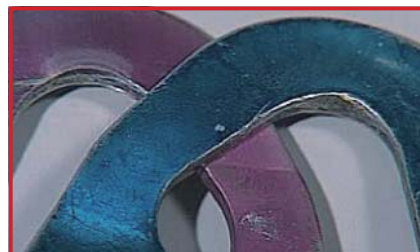
過荷重によるアタッチメントポイントの変形 (注意が必要) 他の症状が出たら廃棄してください
