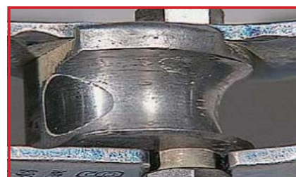
アッパーピンの磨耗 (要修理)
