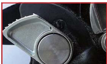
誤操作防止用キャッチのストッパーの破損 (廃棄)
