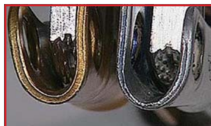
こすれによるフレームの磨耗 (廃棄)
