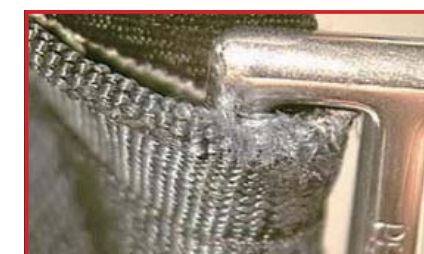
バックルとの接触部分の磨耗 (注意が必要)
