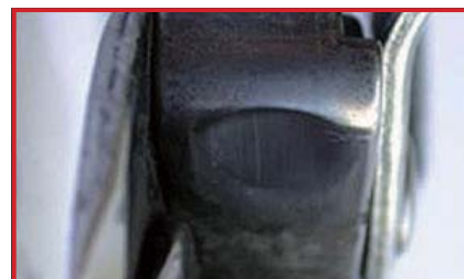
摩擦部分のロープによる磨耗、サイドプレートの鋭いエッジ (注意が必要) 他の症状が出たら廃棄してください
