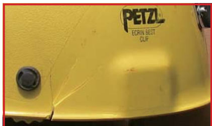
シェルのひび割れ (廃棄)
