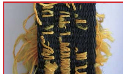
縫い目が裂けたエネルギーアブソーバー (廃棄)
