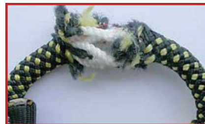
外皮の切断、芯の損傷 (廃棄)
