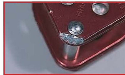
プレートの大きな傷 (注意が必要) 他の症状が出たら廃棄してください
