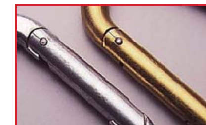
リベット部分でのゲートの割れ (廃棄)
