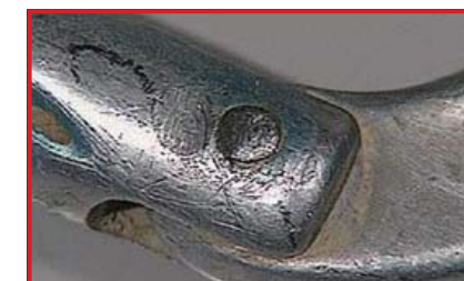
リベットの損傷 (廃棄)
