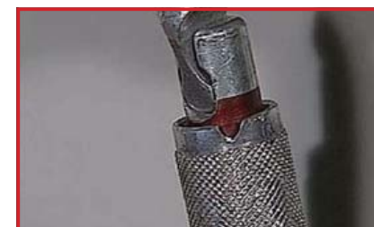
ロックングスリーブの破損 (廃棄)
