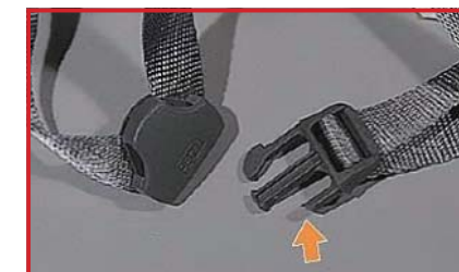
あご紐バックルの破損 (要修理)
