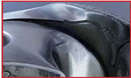
固定サイドプレートの鋭いエッジ (廃棄)
