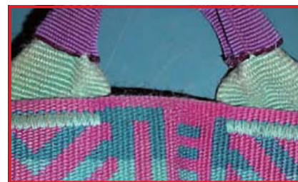
アタッチメントポイントのウェビングの毛羽立ち (注意が必要)
