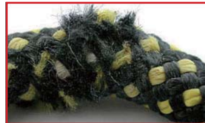
外皮の損傷 (廃棄)
