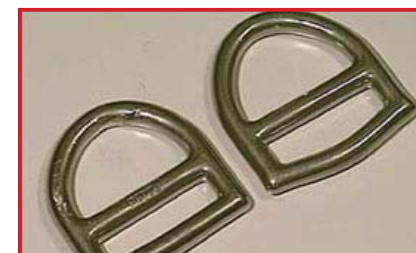
変形している、または傷ついているアタッチメントポイント (廃棄)
