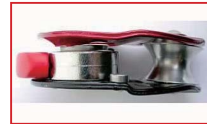
変形により、サイドプレートが閉まらない (廃棄)
