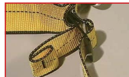
バックルにウェビングを通す向きが逆 (要修理)
