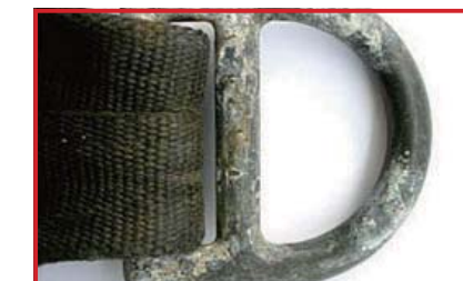
アタッチメントリングの腐食 (注意が必要)
