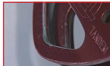
アタッチメントポイントの変形 (注意が必要)
