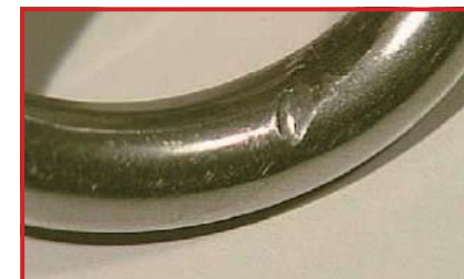
バックルの傷 (注意が必要)
