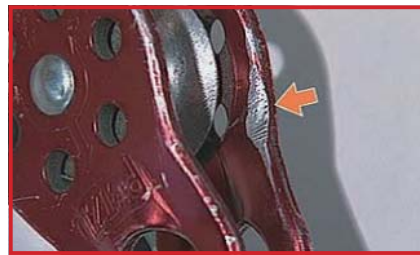
プレートの磨耗 (注意が必要) 他の症状が出たら廃棄してください
