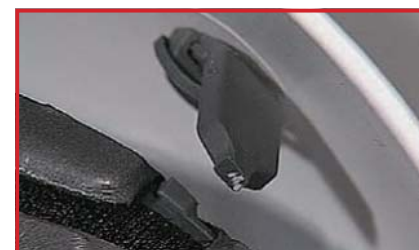
ヘッドバンドを固定するクリップの破損 (廃棄)
