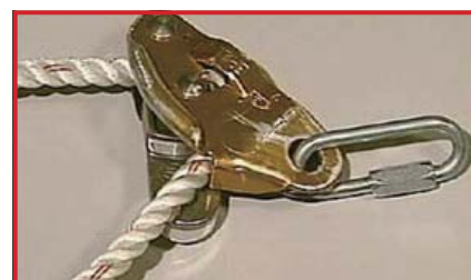
使用できないローブ、コネクタ(要修理) ランヤードのローブは交換できます
