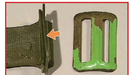
バックルの変形及び腐食 (廃棄)
