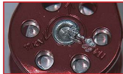
滑車の軸の傷 (注意が必要) 他の症状が出たら廃棄してください
