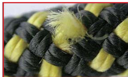
外皮の繊維の損傷。頻繁な点検が必要 (注意が必要)
