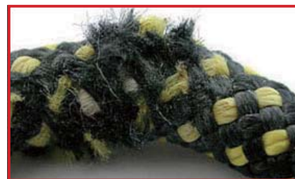
外皮の損傷 (廃棄)
