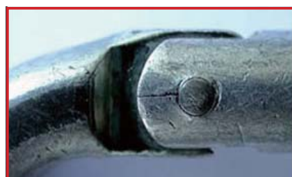
ヒンジ周辺のゲートの割れ (廃棄)
