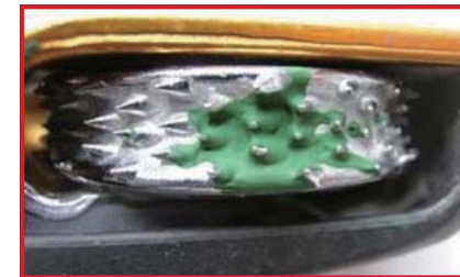
ジャミングローラーの汚れ (要修理)
