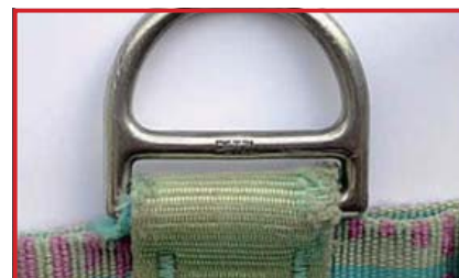
アタッチメントポイント付近のウェビングの縁の擦り切れ (注意が必要)
