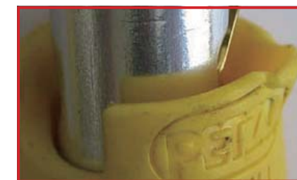
ロックシステムの損傷 (廃棄) 無理にゲートが開けられた跡
