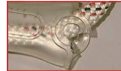
保護カバーの損傷 (要修理)
