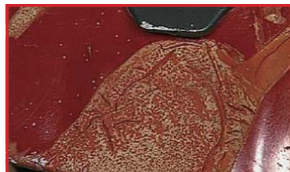
化学薬品による損傷の跡 (廃棄)
