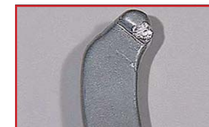
ノーズの損傷 (廃棄)
