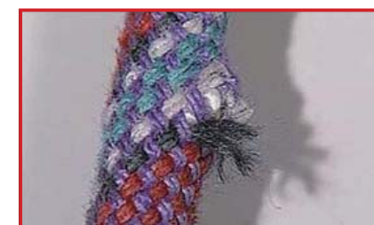
ひっかかりによる損傷(廃棄)
