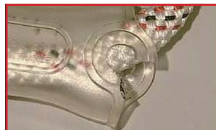
保護カバーの損傷(廃棄) このタイプのカバーは交換できません
