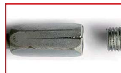
ロックングスリーブの割れ (廃棄)
