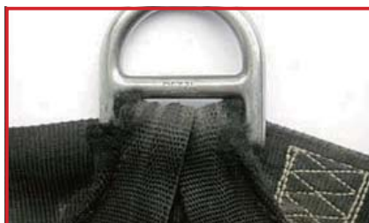
アタッチメントポイント付近のウェビングの縁の擦り切れ (廃棄)
