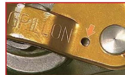
固定ネジの紛失 (要修理)
