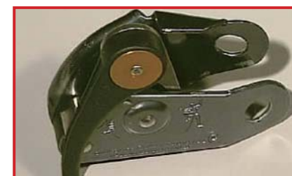
サイドプレートが閉じない (廃棄)
