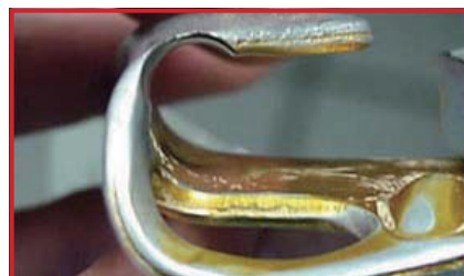
ロープの摩擦によりフレームが磨耗してきた鋭いエッジ (廃棄)
