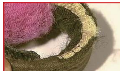
保護カバーの損傷、内部のウェビングも損傷 (廃棄)
