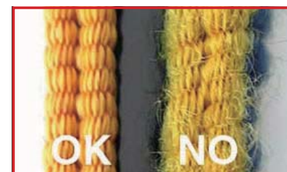
ウェビングの激しい磨耗(廃棄) 毛羽立ってふくらんだウェビング
