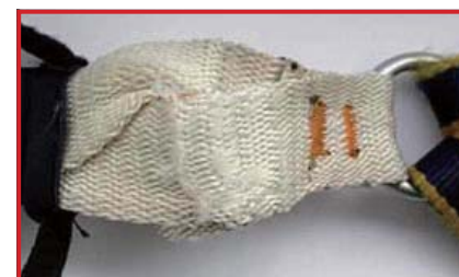
縫い目が裂け始めている エネルギーアブソーバー (注意が必要)
