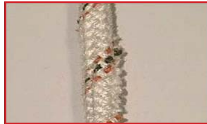
ロープの毛羽立ち (注意が必要) 他の症状が出たら廃棄してください
