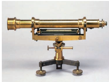
カール・バンベルヒー等水準儀 Precise leveling instrument made by Carl Bamberg
