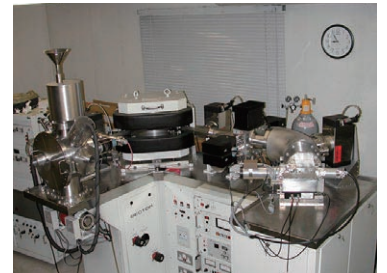
隕石研究に使用する質量分析計 Mass spectrometer used in meteorite research
