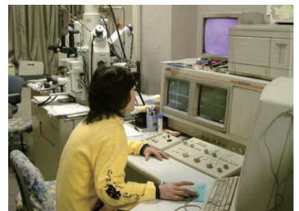
波長分散型分析装置による鉱物の化学分析 Mineral analyses by Wave Spectro-length Dispersive Spectrometer
