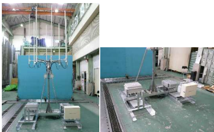
現行基地局とXGP基地局を併設した強度試験
