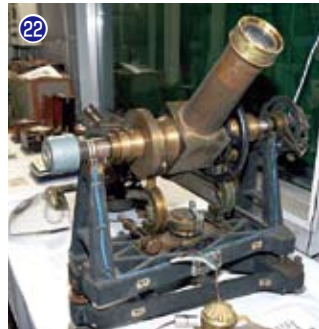
㉒70mmバンベルヒ子午儀：可搬型の本格的な子午儀で、日本各地の経度決定の測量に使われた。
