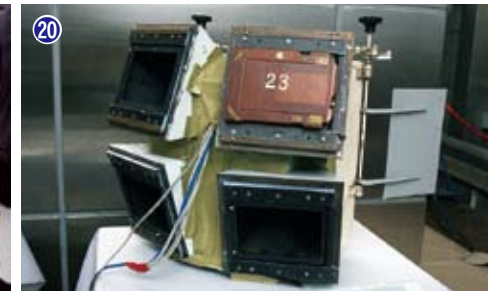
⑳4連流星写真機：レンズ前のセクターを回して流星の速度を測定し、広い視野をカバーした。
