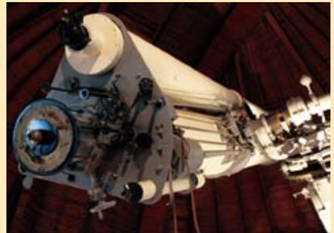
▲ 65cm 屈折望遠鏡は、現在、天文台歴史館となった大赤道儀室で静態保存されている。接眼部の円形プレートにカメラが取り付けられた。
