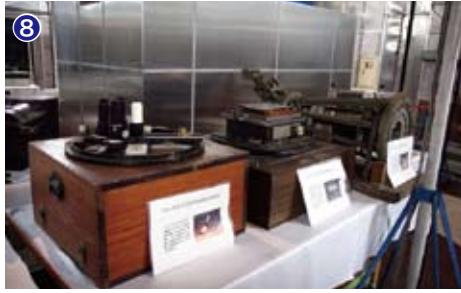
⑧65cm屈折望遠鏡用掩蔽観測接眼部（左）、同撮像カメラ（中・16ページ参照）、同分光器（右）。
