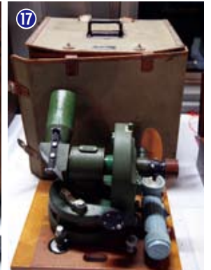
⑰玉屋の緯儀：玉屋は日本最古の測量器械の製作会社。現在も測量機械を作っている。
