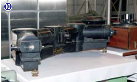
⑩ダブルモノクロメーター：太陽分光写真儀の備品。精度を得るために単色分光器を2段に使用。
