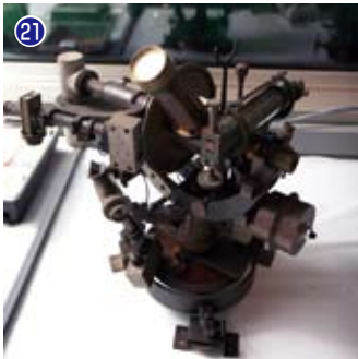
㉑30mmバンベルヒ緯儀：カール・バンベルヒ社製の30mm緯儀。光電観測を試みた改造跡がある。
