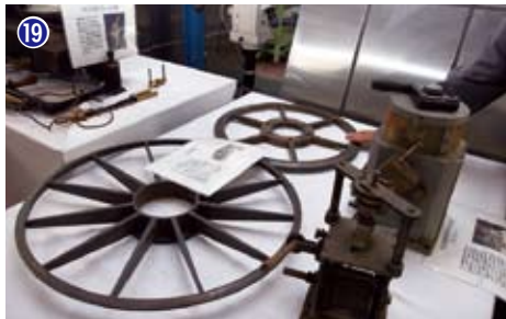
⑲目盛環、赤道儀駆動用時計装置（ガバナー・右）：ガバナーは重錘で電気が不安定な時代に重宝した。
