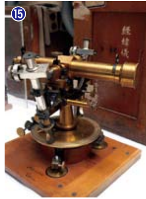
⑮緯儀（測地学委員会測地用緯儀）：水平軸の目盛を読む顕微鏡が2本付いたハイグレード機。
