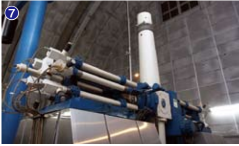
⑦自動光電子子午線：基本星表作成のために1982年に建設された天体の位置観測を行なう望遠鏡。
