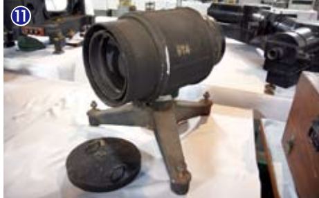
⑪分光器カメラレンズ：太陽分光写真儀の半地下に設置された大型分光器のカメラレンズ。
