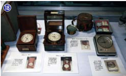
⑱各種クロノメーター：クロノメーターは可搬用の精密時計で、測量地点の経度決定に使用。
