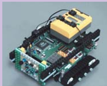
超音波センサにおけるデジタル信号処理システムを取りつけた自律移動ロボット
