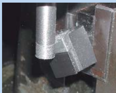
傾斜切削による 外周切削
