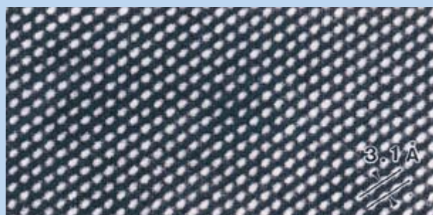
シリコンのイオン除去加工面の原子配列
