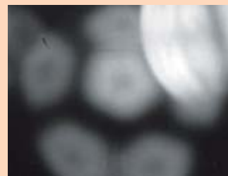
カーボンナノチューブ先端の五員環の存在を示す電子放出パターン
