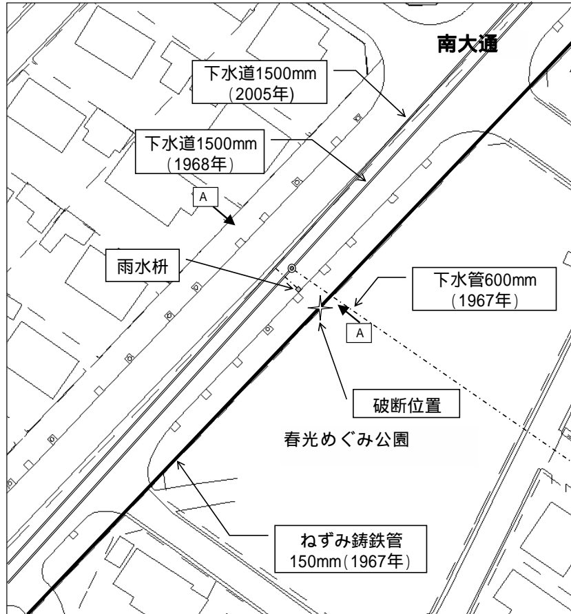
図 1.1.2 春光町付近で破断したガス導管及び周辺埋設物（下水管）に係る平面図
