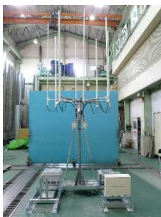
現行基地局とXGP基地局を併設した強度試験
