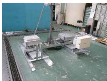
現行基地局とXGP基地局を併設した強度試験
